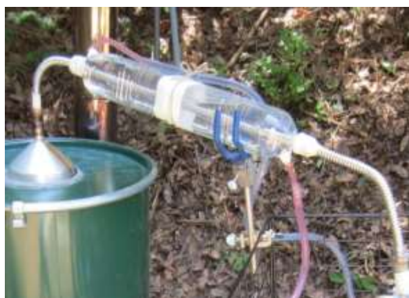
冷却装置(ペットボトルとステンレス製自在管で加工)
