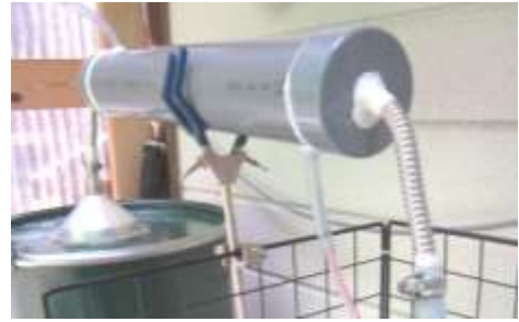
写真-5 塩ビ管を加工した冷却装置
