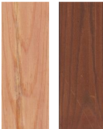
写真-1 左：中温乾燥材 右：熱処理木材
