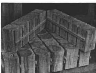
写真-1 木レンガを5個連結した ユニット
