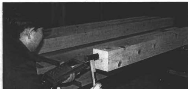
写真-2 基本振動数測定によるヤング係数の測定、重量計と組み合わせることにより自動的に算出される。
