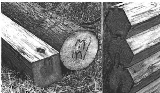
丸太の圧縮成形加工例
