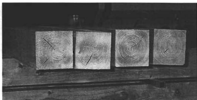
写真-2 乾燥スケジュールによっては内部割れが発生する。（写真はカラマツ）
