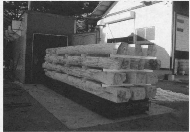
写真-1 タイコ梁の高温セット処理 処理は乾燥装置内で行いました。
