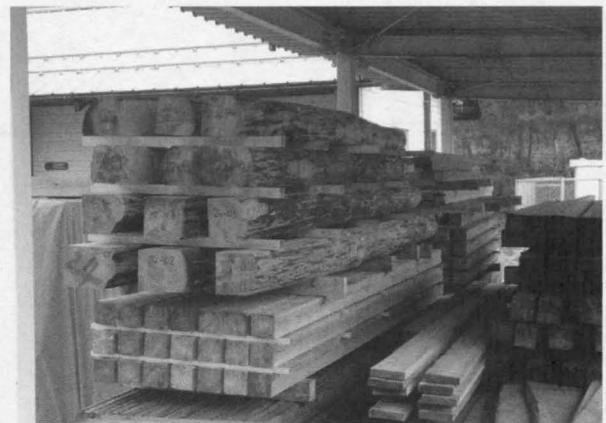
写真-2 タイコ梁の天然乾燥 雨のかからない場所で11ヶ月天然乾燥をしました。
