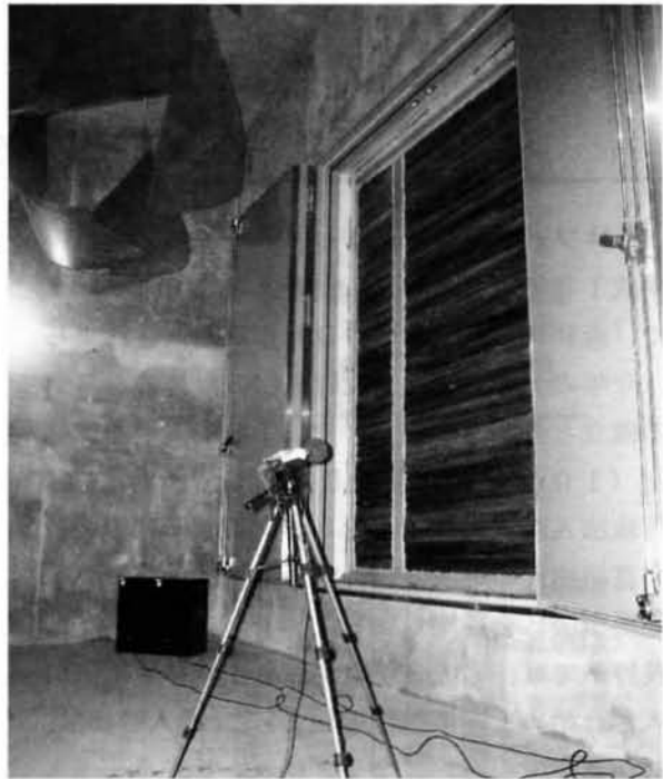
写真-4 カラマツ製遮音壁の音響透過損失の測定
