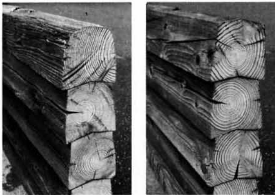
写真-3 遮音板の鋸断面 (左：最上段, 右：中段)
