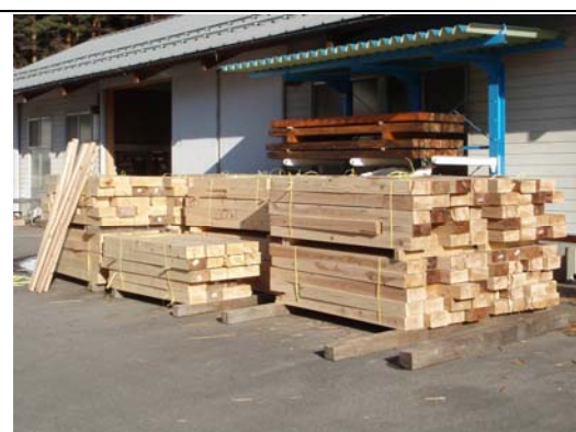
写真 5 試験を終えた材（全体の半数ほど） この後、根太・束・栈木等に再加工されます
