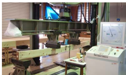
写真 2 曲げ強度試験の様子
