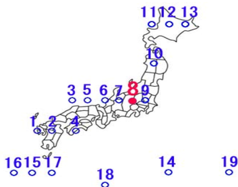
図-2 日本の平面直角座標系原点
