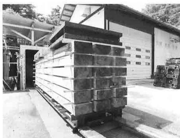
写真2 蒸気圧力併用式乾燥 18体
