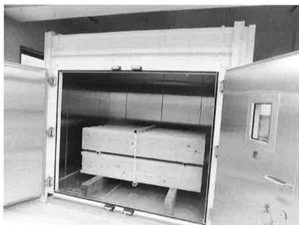
写真-2 恒温恒湿室
