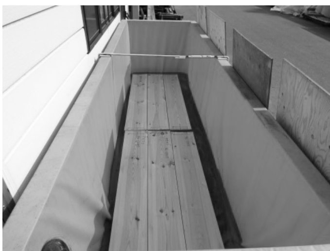
写真 4 事故的水掛りの試験 (72 時間浸せき処理)
