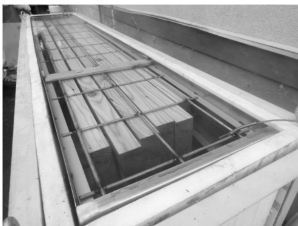
写真5 接着性能試験（煮沸法）
