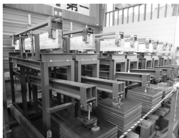
写真7 長期性能試験 （※北海道立総合研究機構林産試験場）
