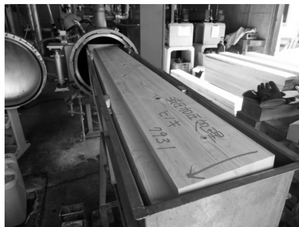
写真6 接着性能試験（減圧加圧法）
