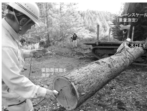
写真 現地での丸太ヤング係数測定状況
