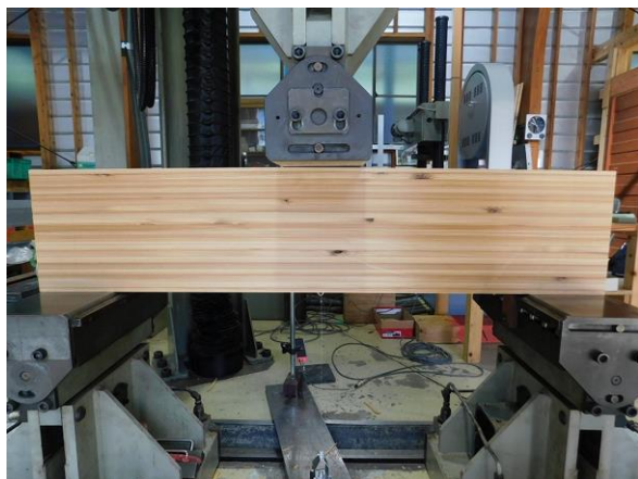
写真-2 圧密集成材せん断試験
