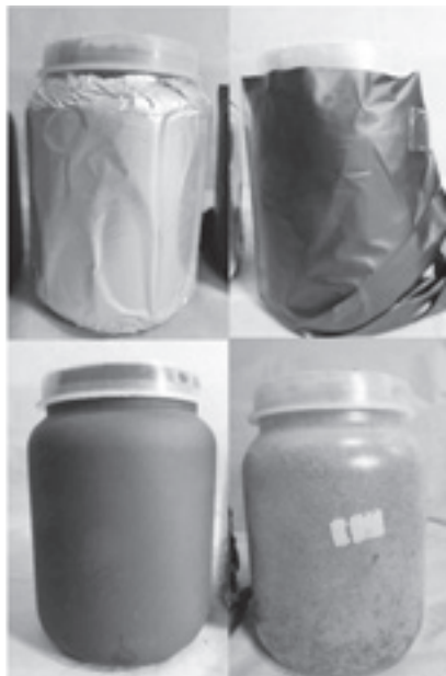
写真2 光を遮断する試験 （左上：アルミ箔で被覆、右上：黒袋で被覆、左下：黒色塗料を塗布、右下：対照区（無処理））
