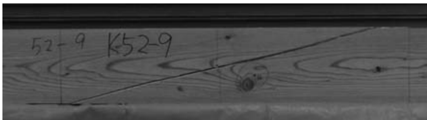
写真-3 供試材の中で最大の繊維傾斜度の供試材の破壊状況
