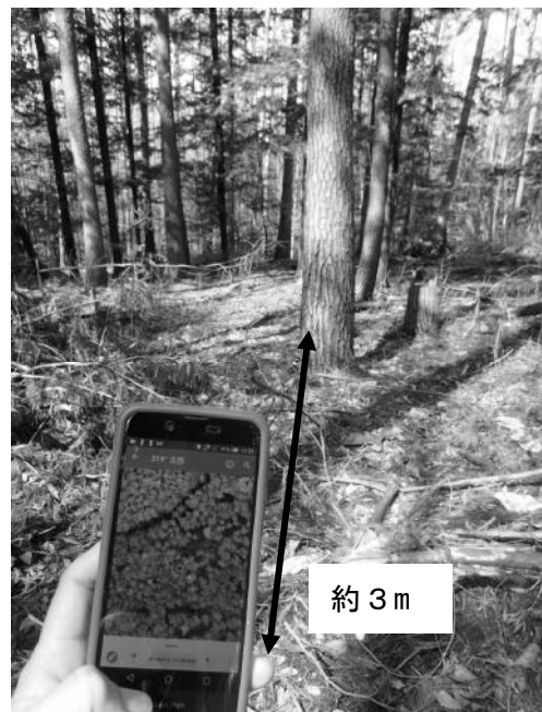
写真-2 スマートフォンに表示させた赤枯れ木の 位置と実際の赤枯れ木の位置関係(誤差約3m)
