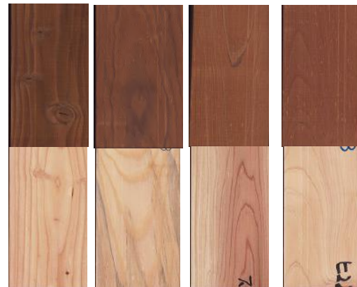
写真-1 供試材 （上段：熱処理材、下段：中温乾燥材 左からカラマツ、アカマツ、スギ、ヒノキ）
