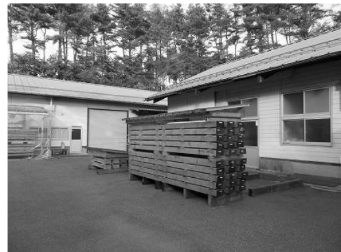
写真-1 人工乾燥後の養生の状況 (上段：人工乾燥後の養生材、下段：天然乾燥材)
