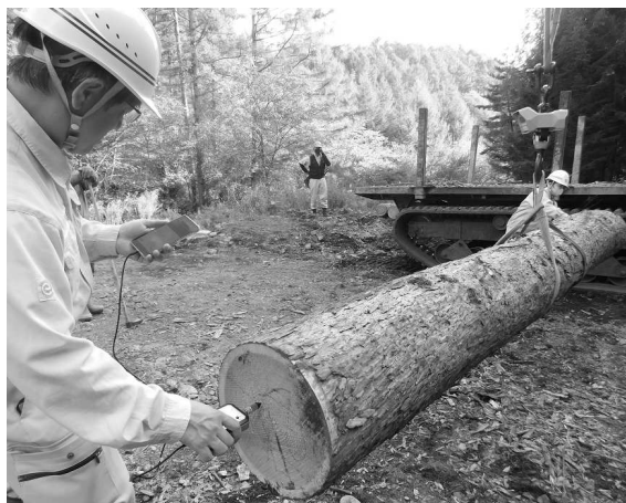
写真 現地でのヤング係数測定の様子
