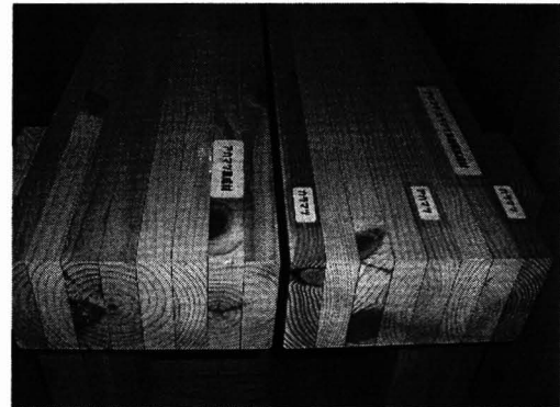
写真-3 アカマツ集成材(左)，アカマツ・カラマツ異樹種複合集成材(右)
