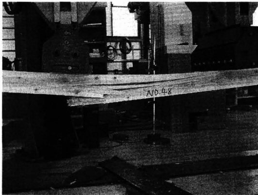
写真-6 エレメントの曲げ強度試験の様子
