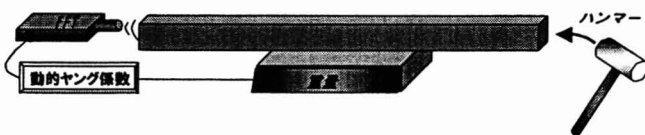
図-3 FFTサウンドアナライザーによる動的ヤング係数(Efr)の測定
