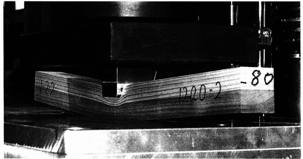
写真 4-8 12a0 における圧縮変形 3 試験体とも、加圧板下の圧縮変形が進むのみで、木口割れは発生しなかった。
