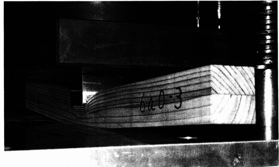
写真 4-14 6a0 における圧縮変形
