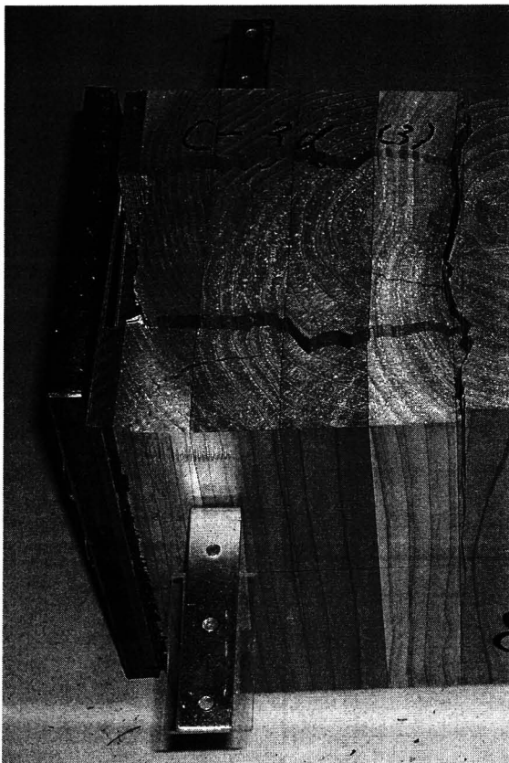
写真 3-2 最終的な破壊形態の「タイプ2」(左)と「タイプ2・3の間中」(右)
