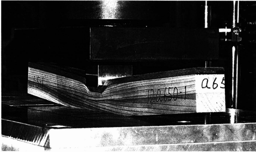
写真 4-5 12a650 における圧縮変形 3 試験体とも、木口割れは発生しなかった。
