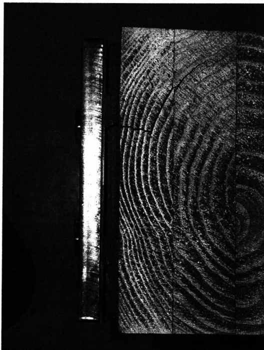
写真 3-1 最終的な破壊形態の「タイプ 1」 (試験体の上面側から撮影)
