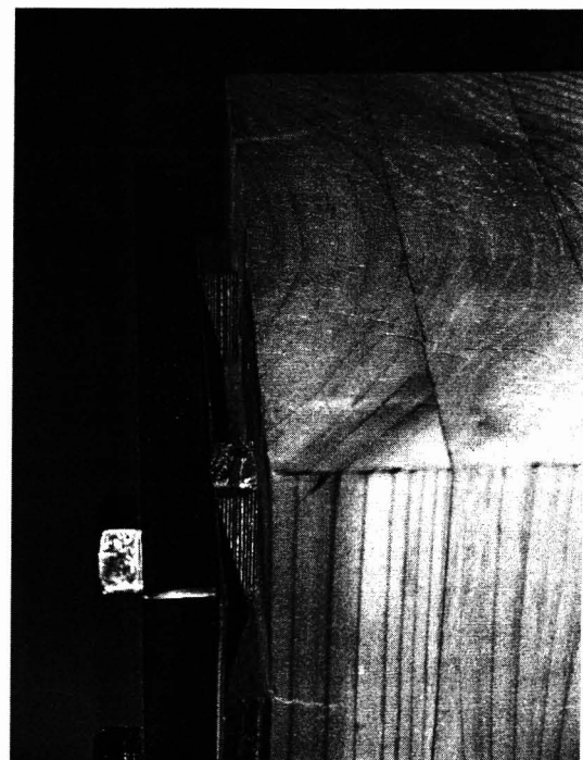
写真 3-1 最終的な破壊形態の「タイプ 1」 (試験体の上面側から撮影)
