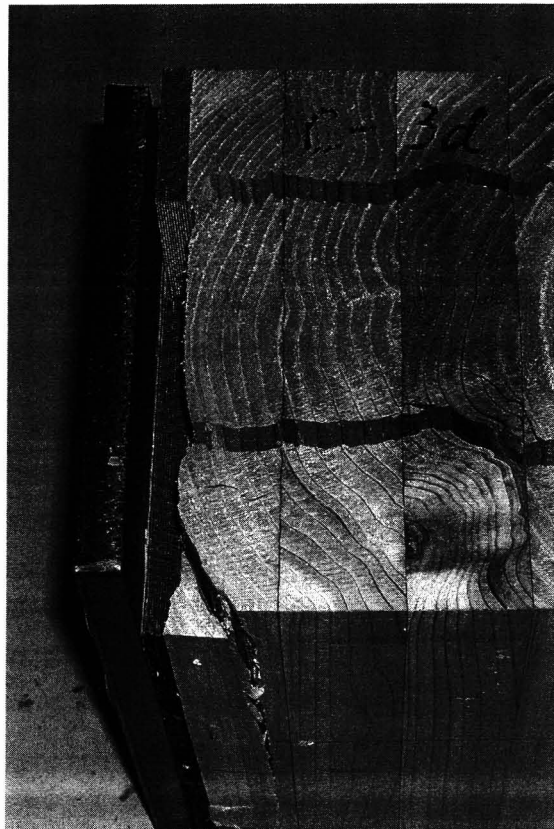
写真 3-2 最終的な破壊形態の「タイプ2」(左)と「タイプ2・3の間中」(右)
