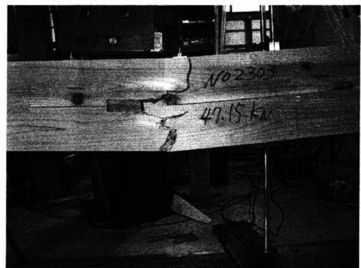
写真-16 単純曲げ破壊 (ツインビーム)
