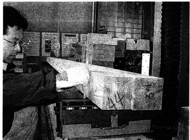
写真-4 接着重ね梁のねじれの測定
