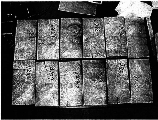
写真-7 はく離試験(煮沸)終了後の試験片
