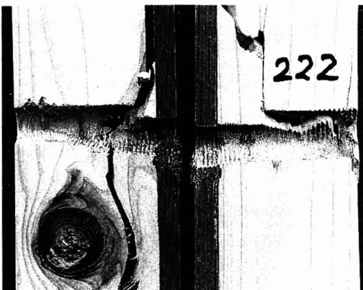
写真 3-8 CF13-7d の最終破壊形状 (試験体 No. 222)
