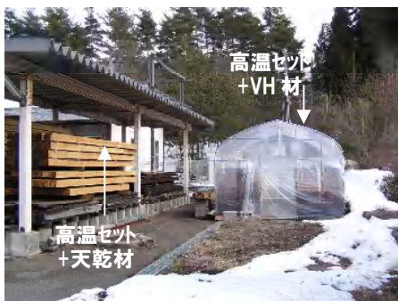
写真-1 構内に設置されたビニールハウス（右）とコントロール材の置かれた天然乾燥場（左）の様子
