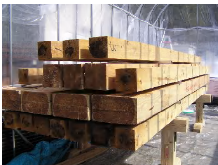
写真-2 ビニールハウス内に置かれた4m柱材と桁材
