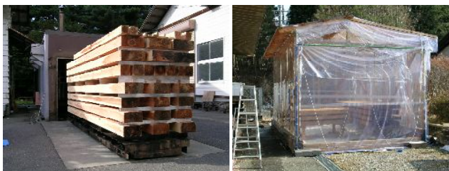
写真-10 太陽熱利用乾燥の様子 左：蒸気式木材乾燥装置での高温セット処理 右：ビニールハウス乾燥
