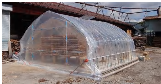
写真-8 現在、実験中の二重構造ビニールハウス （2009. 11. 18）
