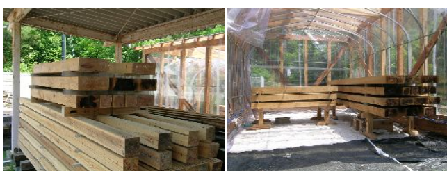
写真-11 乾燥室内の様子 左：屋外天乾場での乾燥 右：ビニールハウス内での乾燥
