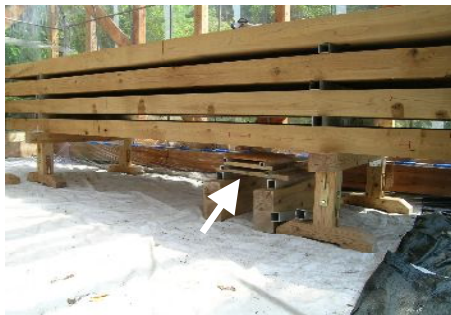
写真 - 12 平衡含水率測定用板材のビニールハウス内の設置位置
