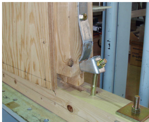
写真 4-1 柱脚固定金物破断 (24k-3 試験体)
