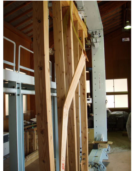
写真 2-1 筋かいの座屈 (No. 1 試験体)
