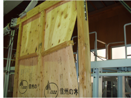
写真 5-2 D12-3 試験体 (試験後)
