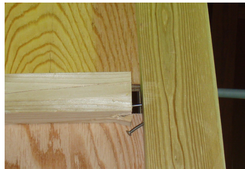
写真 5-3 D24-1 試験体 (柱・横棧接合部)
