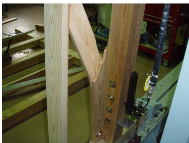
写真 3-1 c1 試験体筋かい破断
