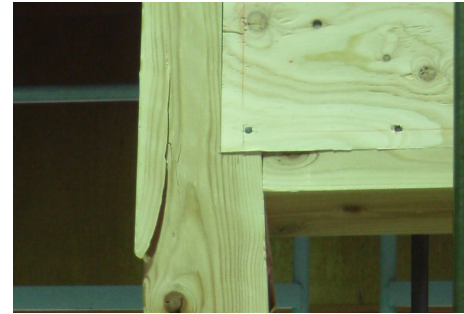
写真 6-3 B-1 試験体 (柱破壊部)
