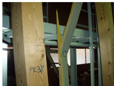
写真 3-2 g2 試験体圧縮側筋かい
