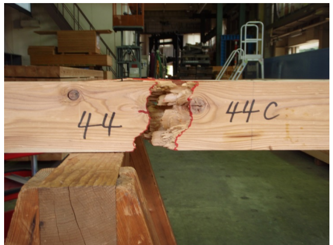
写真-2 過度の高温乾燥カラマツの破断
