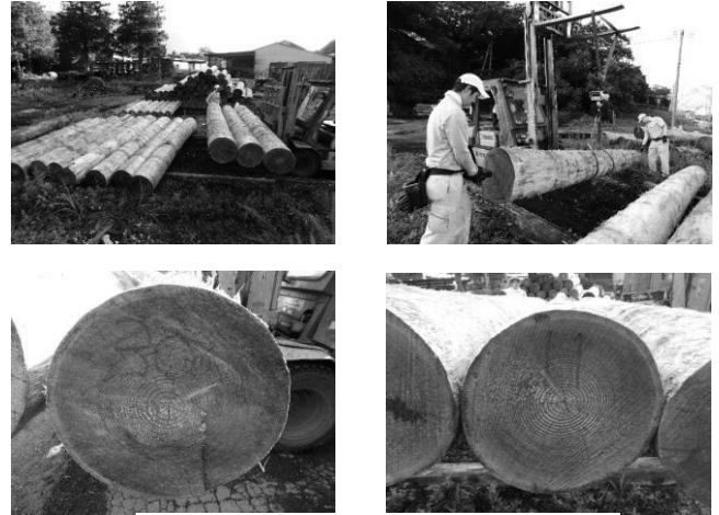
写真 1-1 カラマツ丸太供試体と測定状況
