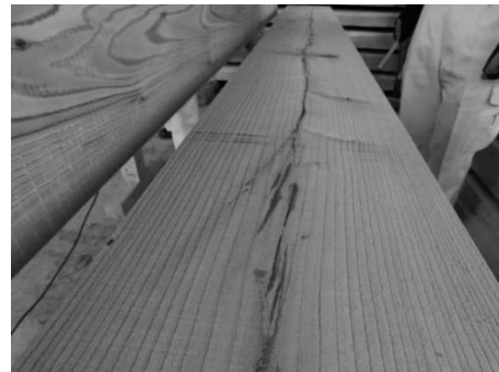
写真4-11 製材時に髓を割ると髓割れが生じる(カラマツ)
