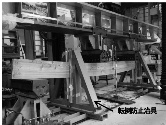
写真4-3 曲げ試験の様子
