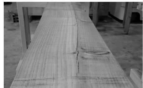
写真4-13 乾燥後の髓割れ(材面割れ)(スギ)
