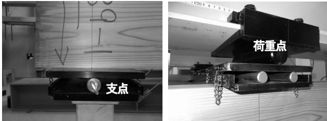
写真 6-2 支点及び荷重点の支持の状況
