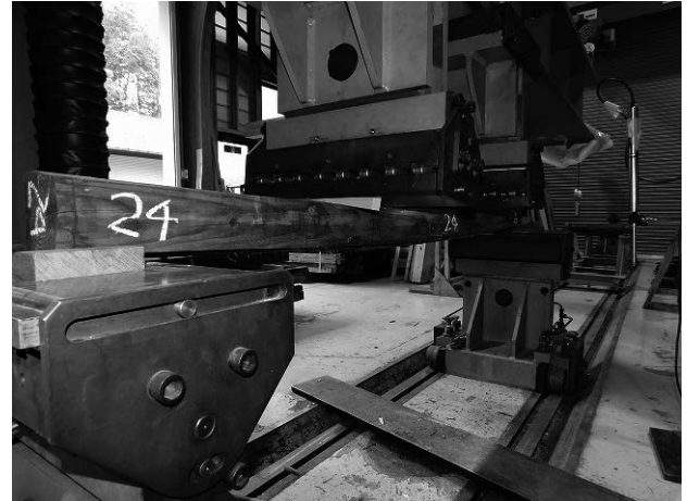
写真-4 静的曲げ試験の状況
