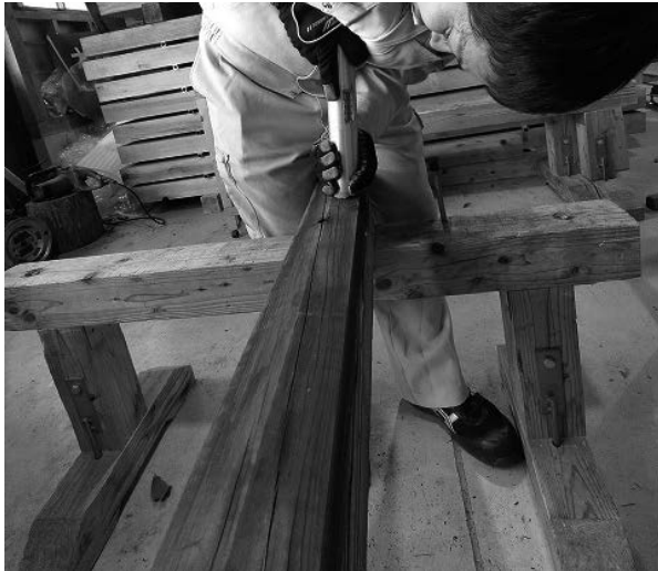
写真-3 ピロディン測定状況
