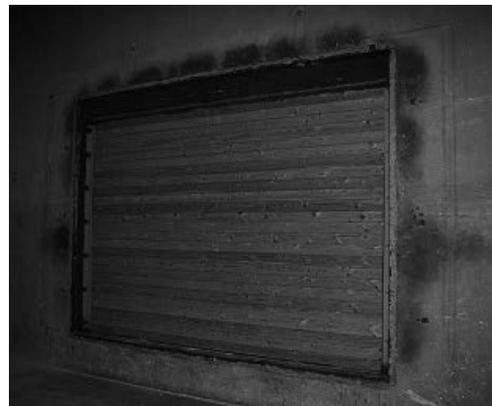
写真-1 音源室側から見たカラマツ製試験体
