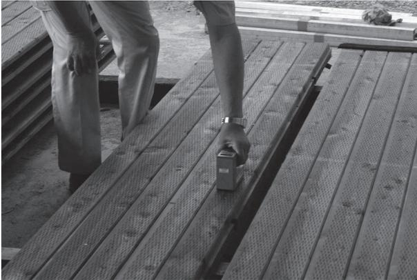
写真-4 納品時の含水率測定
