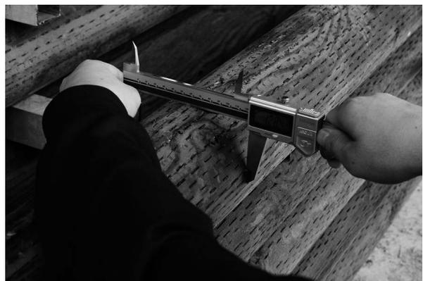
写真-3 納品時の寸法測定
