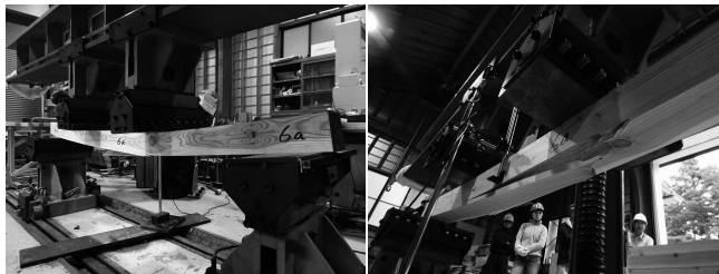
写真-4 最も曲げ強さの低かった試験体の破壊状況
