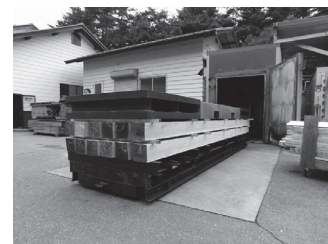
写真-2 人工乾燥の様子
