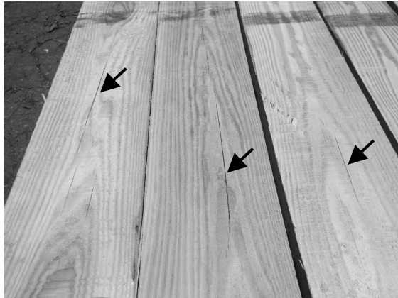
写真6 乾燥後の材面割れの一例 (心持ち材)
