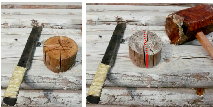
（左：加撃側、右：測定側 点線が基準線） 写真-1 割裂試験
