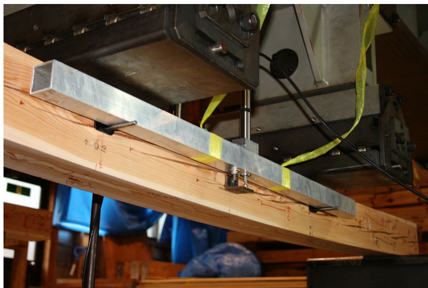
写真-2 上部荷重点間におけるEbtrueの測定
