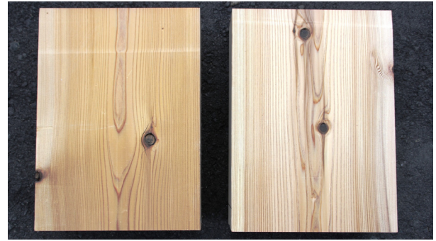
写真-5 材色の違い(一例) 左:弱加圧型乾燥, 右:蒸気・圧力併用型乾燥
