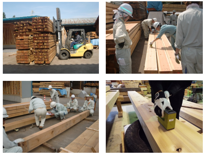
写真-3 乾燥試験における形質調査
