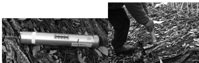
写真 3-1-3 ピロディンによる貫入値の測定 (左: ピロディン, 右: 測定状況)
