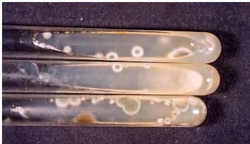
写真-7 発生室で散布する水から検出された糸状菌およびバクテリア (25℃ 7日間)
