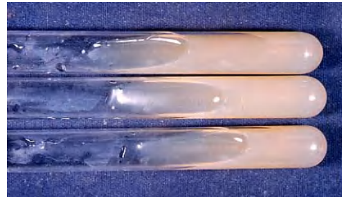
写真-8 左のコントロールとした総合センターの水の結果 (25℃ 7日間)
