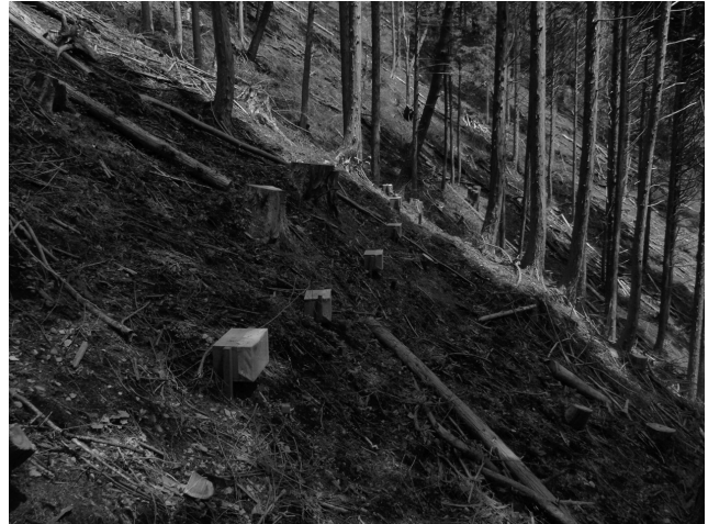
写真-1 土砂受け箱設置状況
