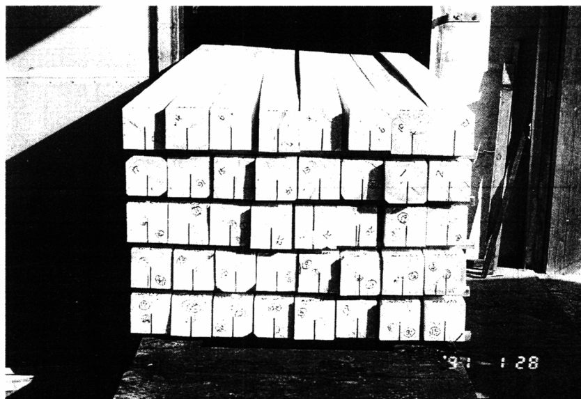
写真-1 ヒノキ柱材の人工乾燥前の状態 上半分……一般材 一般材のアテによる曲がりがよくわかる。下半分……葉枯らし材
