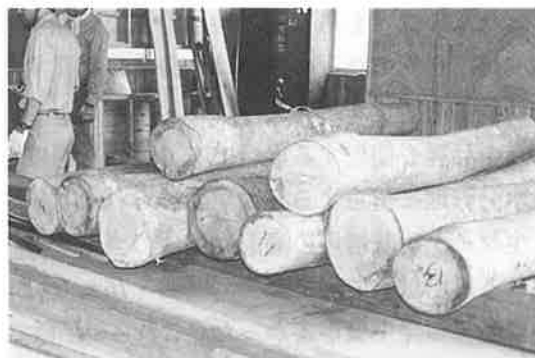
写真1 供試材としたケヤキ中小径材
