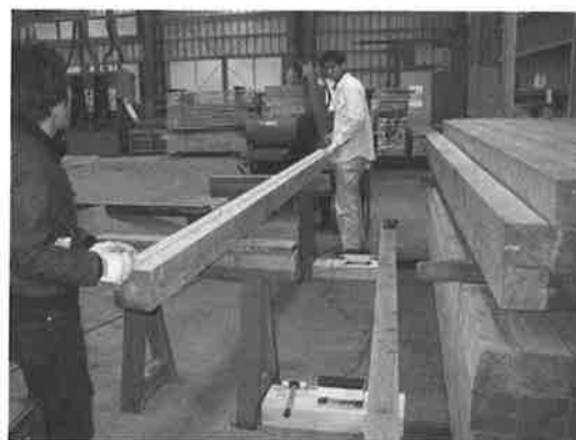
写真-1 縦振動ヤング係数等の測定
