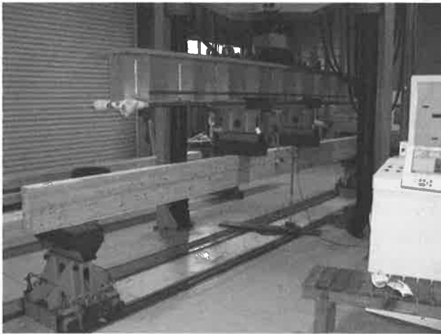
写真 3-1 集成材の曲げ試験
