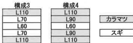
図 3-2 集成材のラミナ構成(めり込み, せん断試験用) ラミナの等級区分は MOE_{AVG} で行い, 試験は平成 18 年度に実施した。
