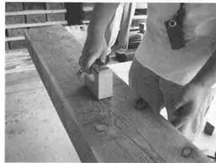
写真4 含水率計での含水率測定
