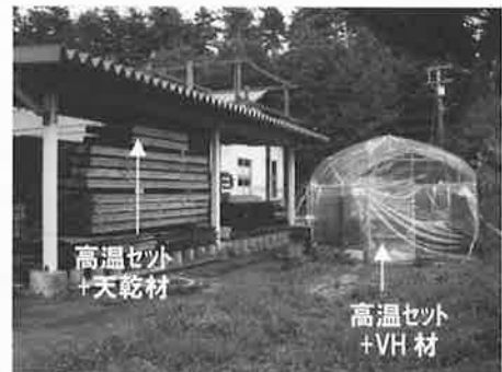
写真-3 コントロール材の置かれた天然乾燥場（左）とビニールハウス（右）の様子
