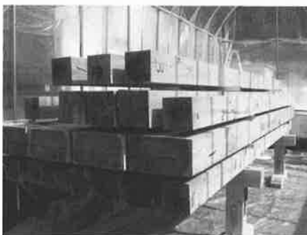
写真-2 ビニールハウス内に置かれた4m柱材と桁材
