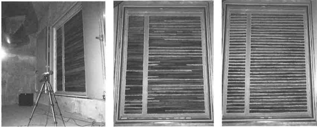
写真-4 カラマツ製遮音板の音響透過損失の測定（音源室側から見た状態） 左側から「シールなし」「大きな隙間のみシール」「すべての隙間をシール」の状態
