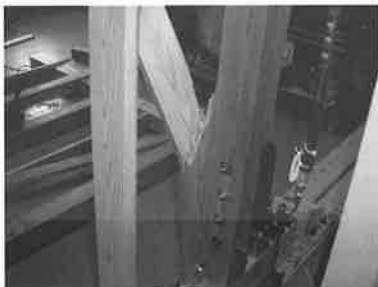
写真 3-1 c1 試験体筋かい破断
