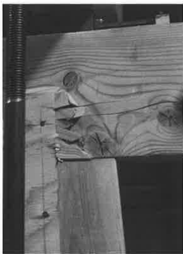
写真 6-1 A-2 試験体 (梁破壊部)
