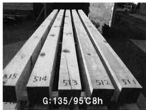
写真-3 材面割れの様子 (アカマツ)
